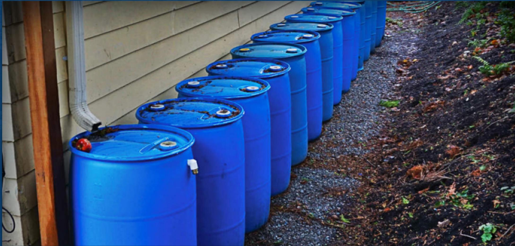
**Exemplo de sistema básico para a captação e retenção de águas pluviais**
