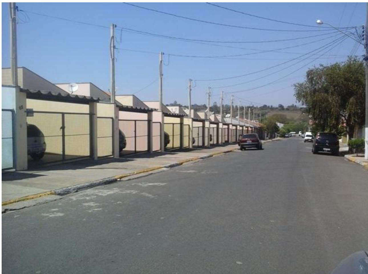
**FOTO 32:** Situação comum de extensão de acesso do carro sobre a sarjeta, prejudicando a drenagem da via.
