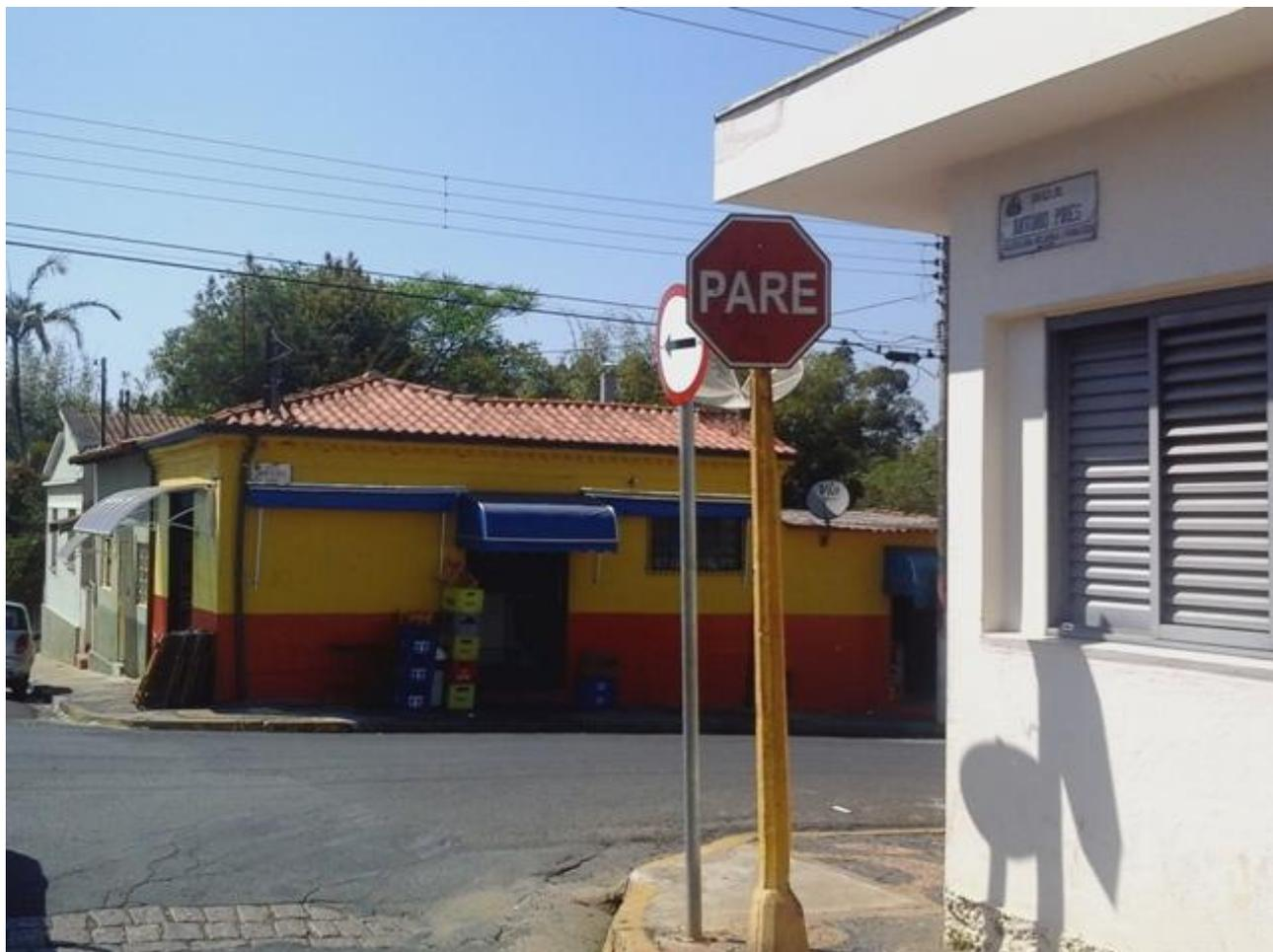
**FOTO 13:** Excesso de suportes para sinalização diminuindo o espaço para circulação de pedestres.
