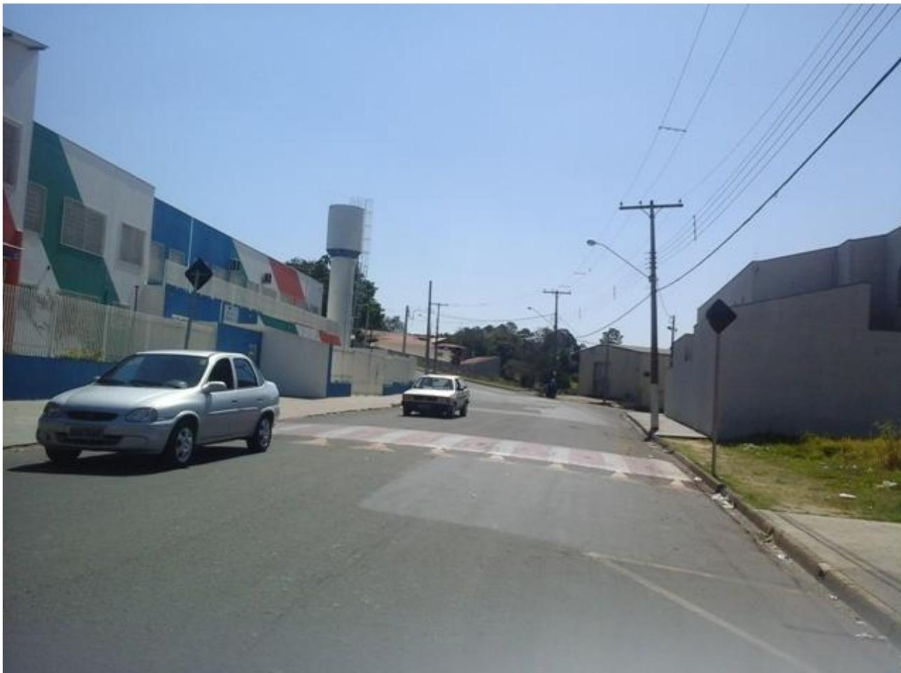
**FOTO 17:** Lombofaixa é uma boa solução para muitas das travessias da cidade, diminui a velocidade, coloca o pedestre em evidencia, sendo visto a uma boa distância.
