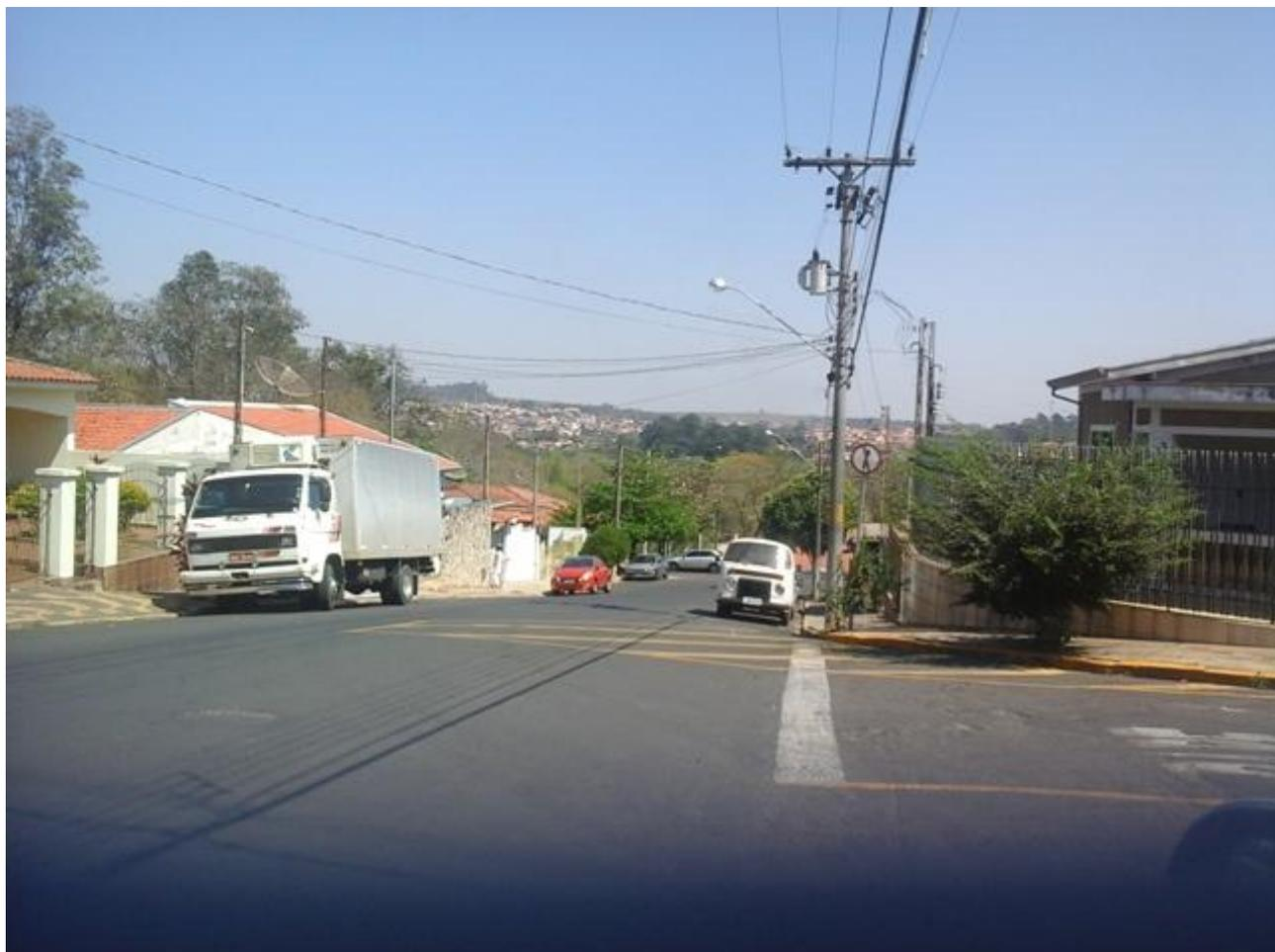
**FOTO 09:** Sinalização insuficiente em face da largura das vias, recomenda-se neste caso o uso de restrição física e complementação da sinalização.
