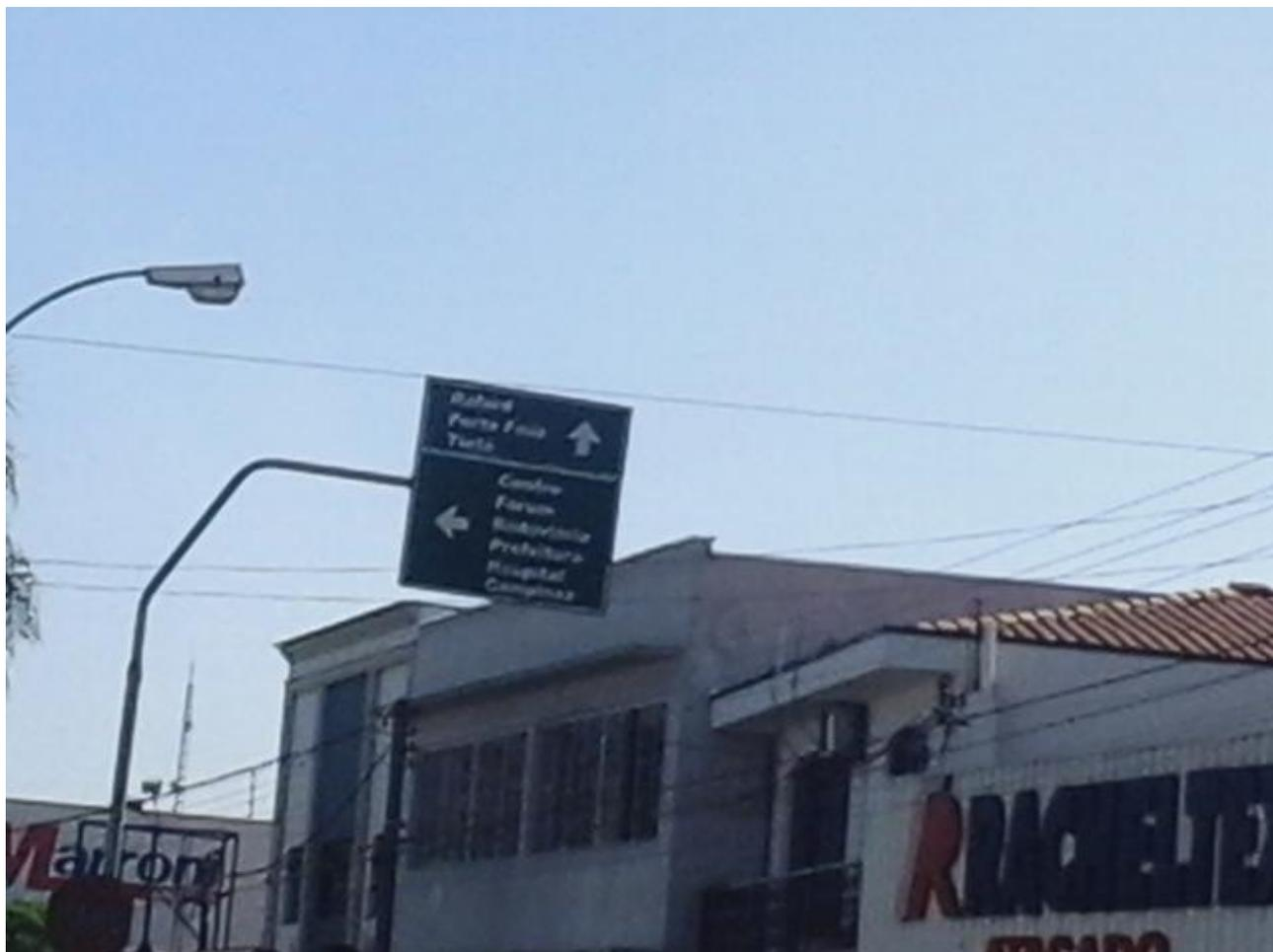
**FOTO 08:** Placa com excesso de informações e para piorar mais do que 3 informações em um sentido, esta situação está em desacordo com as Normas vigentes, revela ainda a urgência em redefinição do Programa de Sinalização de Orientação do Tráfego em Capivari.
